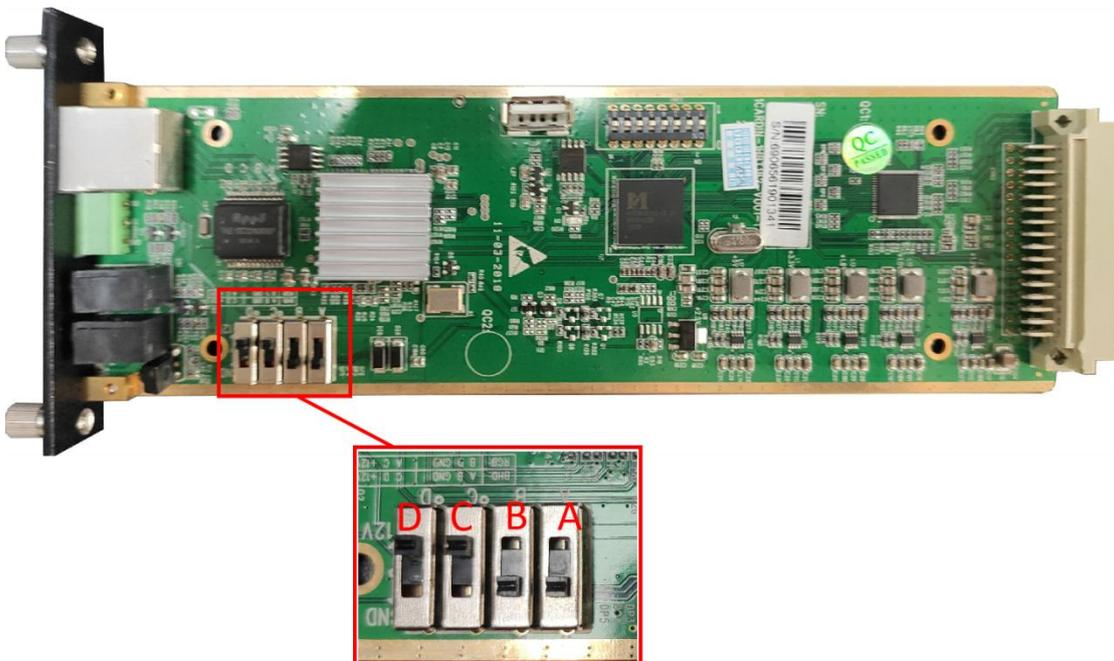
如上图所示 A,B,C,D 四个拨动开关，A B 往板卡外拨、C D 往板卡内拨，即打开 POC 供电！
