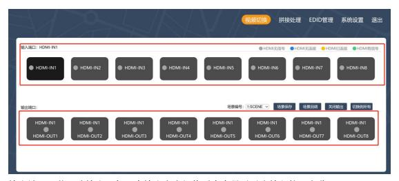
输出端口: 共8路输出,每一个输出上方切换后会有显示对应输入接口名称功能按键: 共4个按键: 场景保存、场景回调、关闭输出、切换到所有
