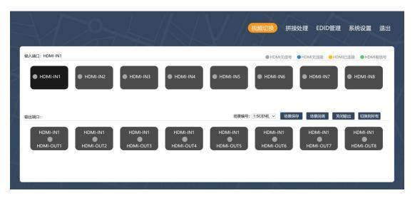
输入端口: 共8路输入端口, 指示灯共4种状态: 无信号、无连接、已连接、有信号
