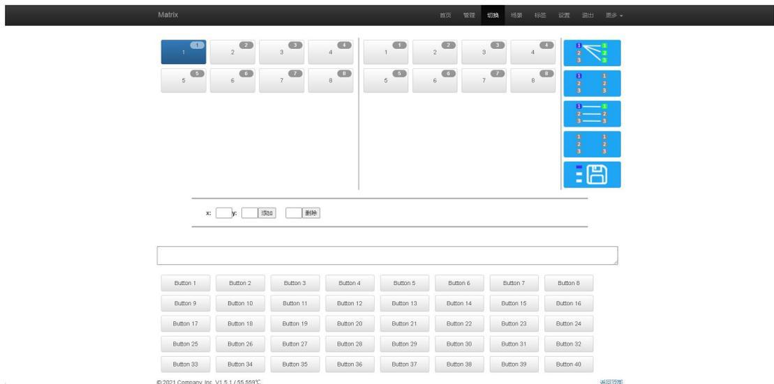
竖线左边区域为输入区域，竖线右边区域为输出区域；最右边有 5 个快捷按钮，从上往下分别为切换所有、关闭单路、一一对应、关闭所有、场景。（所有的输入输出端口均可改名，见命名操作说明）；中间的部分为设置拼接墙；最下面为多功能按键区域，通过简单的设置，可以通过串口控制外围设备，如投影机的开关。无设置时是场景的调用快捷按钮。（详情见“设置”多功能按键设置说明）
