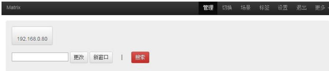
在同一个局域网中，可同时控制多台同一网段不同 IP 地址的矩阵，最多可以同时控制 254 台矩阵。如下图连入 IP 为 192.168.1.81 和 192.168.1.88 两台矩阵，其中 192.168.1.81
