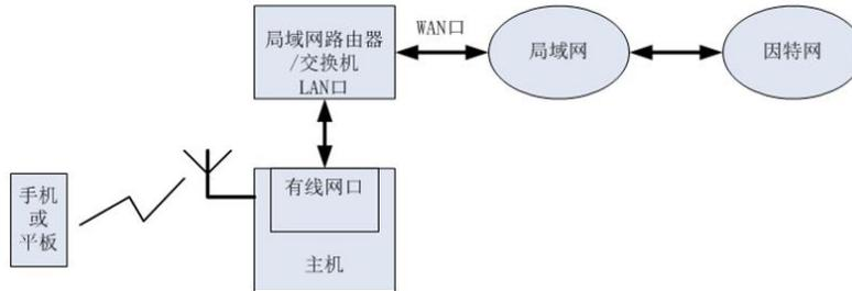
\*插上网线后需重启主机，不然在 WEB 界面的网络设置里不会显示有线设置，一般默认自动获取网络，如需使用静态网络，把 DHCP 功能关闭即可设置接入网络的 IP 地址。
